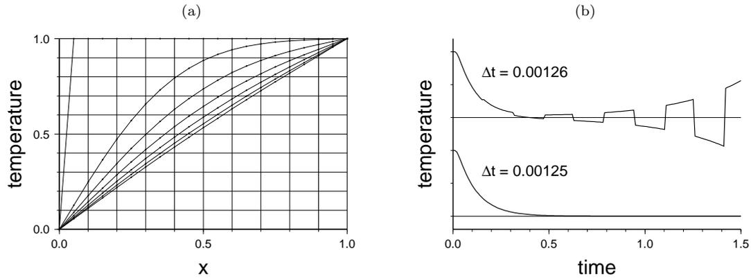
図1: 「等温壁」の結果 (ただし  $h = 1/N = 1/20$ )。 (a) 時刻  $t = 0$  から 0.3 まで、時間間隔 0.05 で温度場をプロットした。時間積分のステップ幅は  $\Delta t = 10^{-4}$ 。 (b) 中点  $x = 0.5$  での温度の時間変化のようすをしめす。上は時間積分の刻み幅が  $\Delta t = 1.26 \times 10^{-3}$  の場合、下は  $\Delta t = 1.25 \times 10^{-3}$  の場合。  $\Delta t$  が限界値 (約  $1.258 \times 10^{-3}$ ) を超えると、数値解が振動的に発散していくことがわかる。
