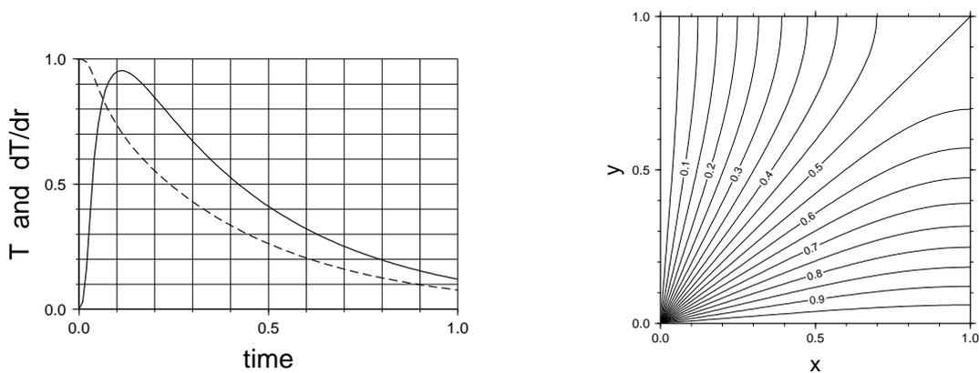
図3: 「断熱壁」の問題をクランク・ニコルソン法で計算した結果 (ただし  $h = 1/N = 1/20$ ,  $\Delta t = 10^{-2}$ )。図2 (b) と同様、中点  $x = 0.5$  での温度勾配 (実線) および右端  $x = 1$  での温度 (破線) をそれぞれ時間の関数としてプロットした。
