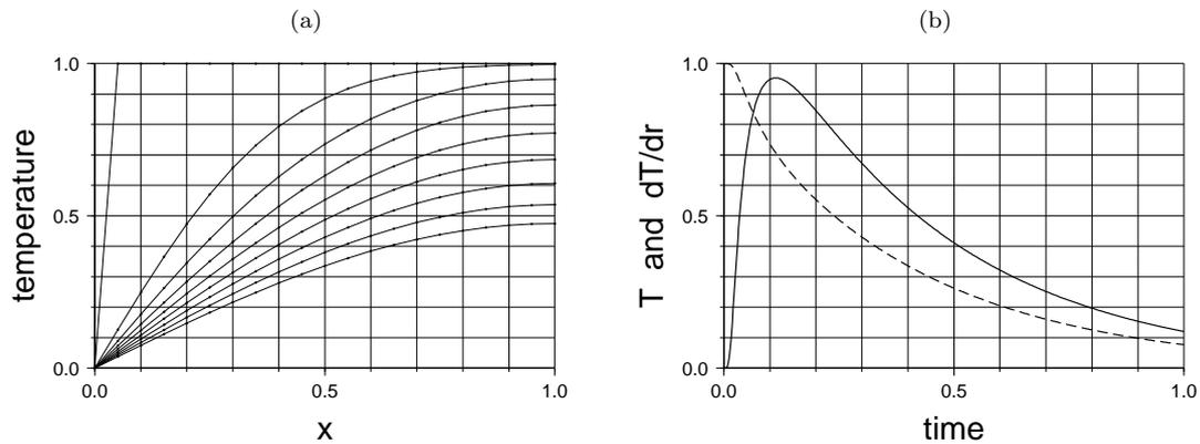
図2: 「断熱壁」の結果 (ただし  $h = 1/N = 1/20$ ,  $\Delta t = 10^{-4}$ )。 (a) 時刻  $t = 0$  から 0.4 まで、時間間隔 0.05 で温度場をプロットした。 (b) 中点  $x = 0.5$  での温度勾配 (実線) および右端  $x = 1$  での温度 (破線) をそれぞれ時間の関数としてプロットした。
