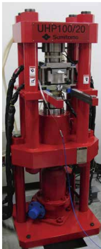
図2. 高温高压岩石変形試験機. 住友重機械(株)製 100 トンプレス。
