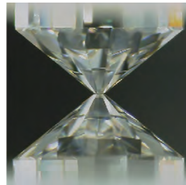
図1. ダイヤモンドアンビルセルに用いる単結晶ダイヤモンドアンビル。直径約3mmのダイヤモンドを二つ使用する。
