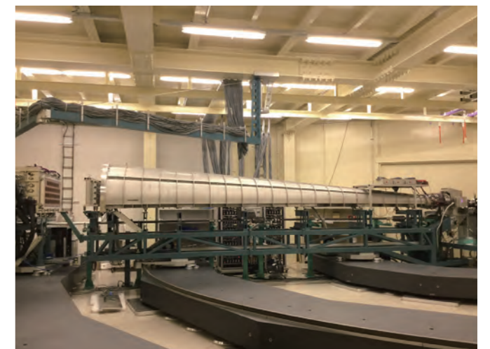
図3. SPring-8 のビームライン BL43LXU に設置された非弾性 X 線散乱分光器。X 線のエネルギーの変化を測定することにより高圧高温下での試料の弾性波速度がわかる。
