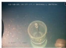
図1 JFAST掘削航海で設置した温度計アレイの様子。
